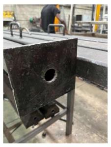
Los moldes se presionan sobre la salida del extrusor mediante una mordaza, lo que permite a los operadores realizar cambios de molde de manera simple y eficiente. Los moldes simplemente se colocan sobre perfiles cortados a la altura adecuada para mantener los moldes en posición horizontal.
