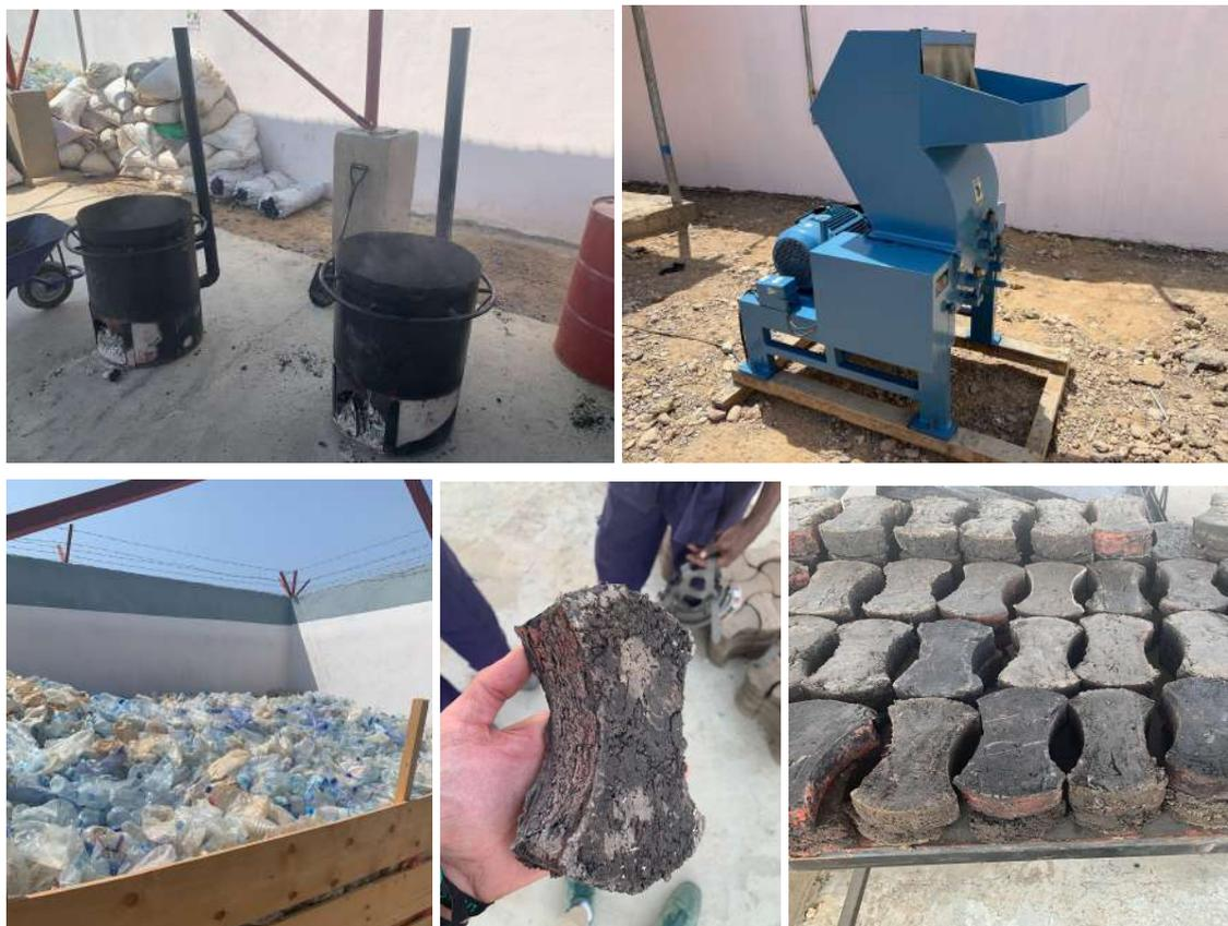
Par la suite, le projet s'est équipé de machines pour le reste de la chaîne de transformation : extrusion et presse / moule, en se concentrant sur des pavés résidentiels d'abord. Un agglomérateur a aussi été ajouté pour traiter les plastiques souples et le broyeur a été ajusté pour remplir plus efficacement sa mission.
