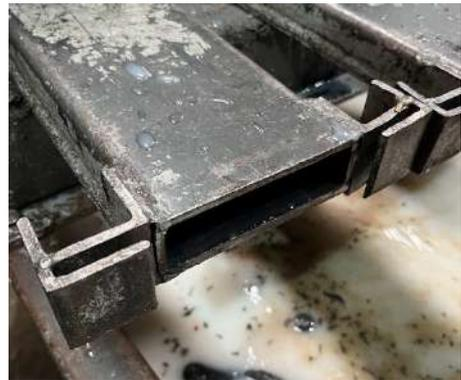
Une fois les moules remplis, la vanne trois voies est commutée afin de remplir un second moule déjà en place et vide. Le moule fraîchement rempli est plongé dans le bain juste en dessous rempli d'eau et d'huile de coupe miscible dans l'eau. L'huile de coupe permet d'éviter la corrosion et de faciliter le démoulage en lubrifiant le moule. En immergeant le moule chaud, on diminue le temps de prise du plastique ce qui aidera également au démoulage.
