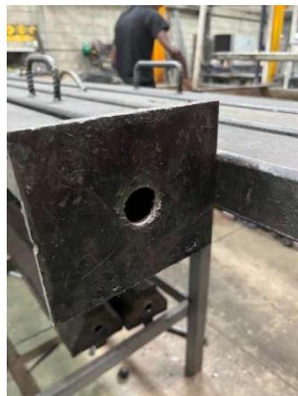
Les moules sont pressés sur la sortie de l'extrudeuse par une pince étau, ce qui permet aux opérateurs d'effectuer les changements de moules de manière simple et efficace. Les moules sont simplement posés sur des profilés découpés à la bonne hauteur pour garder les moules à l'horizontal.
