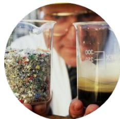
*La pyrolyse est un procédé qui consiste à chauffer le plastique sans oxygène pour casser les longues molécules polymères (sous forme solide) et en faire des molécules plus légères (liquide puis gazeux). Avec 1Kg de plastique, on peut obtenir jusqu'à 1L de carburant, diesel et essence.*
