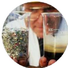
*A pirólise é um procedimento que consiste em aquecer o plástico sem oxigênio para quebrar as longas moléculas dos polímeros (sob a forma sólida) e produzir moléculas mais leves (líquidas e depois gasosas). Com 1Kg de plástico, podemos obter até 1L de combustível, diesel e gasolina.*
